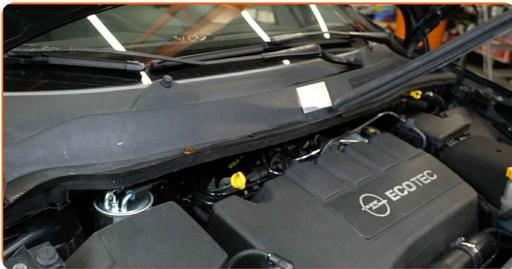
**4** Αφαιρέστε τα καπάκια των βιδών του βραχίονα του υαλοκαθαριστήρα του παρμπρίζ. Χρησιμοποιήστε ένα εργαλείο αφαίρεσης κλιπ.
