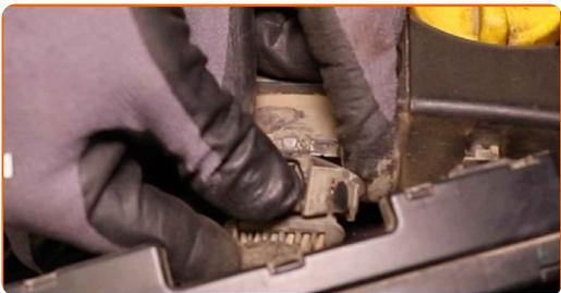
**5** Ξεβιδώστε τα μπουλόνια του πολλαπλασιαστή. Χρησιμοποιήστε ένα Τορξ T40. Χρησιμοποιήστε μια καστίνα.
