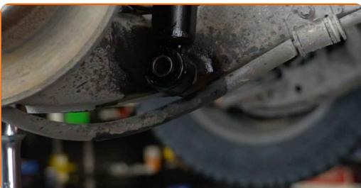
10 Αφαιρέστε τη βάση κάτω από τον πίσω εγκάρσιο άξονα.
