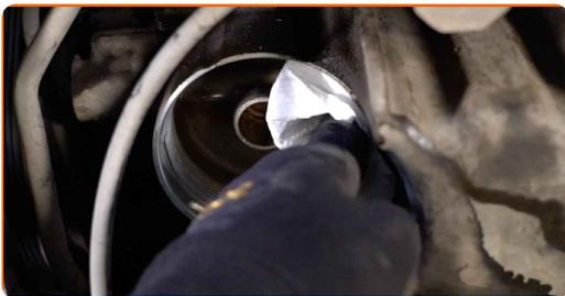
**18** Τοποθετήστε το καινούριο φίλτρο λαδιού στη θέση του επάνω στο περίβλημά του.
