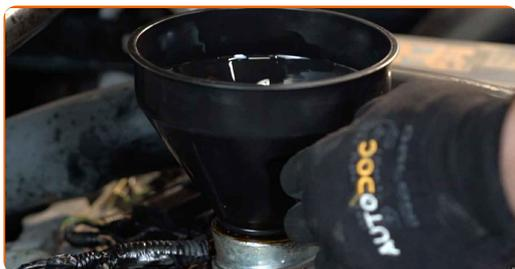
**27** Ρίξτε καινούριο λάδι στον κινητήρα στην ποσότητα που συνιστάται από τον κατασκευαστή του αυτοκινήτου.
