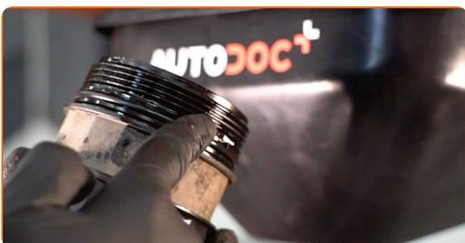
**20** Βιδώστε το φίλτρο στη θέση του. Χρησιμοποιήστε ένα καρυδάκι 86/14-F. Χρησιμοποιήστε ένα δυναμόκλειδο. Σφίξτε το με ροπή 25 Nm.
