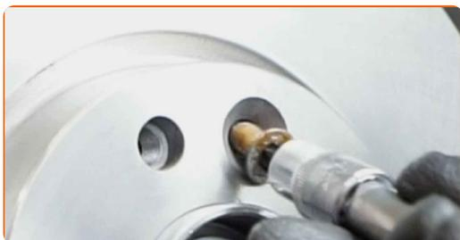
**26** Σφίξτε τα στοιχεία στερέωσης των δισκόπλακων. Χρησιμοποιήστε ένα Τορξ T50. Χρησιμοποιήστε ένα δυναμόκλειδο. Σφίξτε τη με ροπή 15 Nm.
