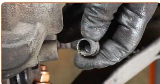
**11** Ξεβιδώστε τα στοιχεία στερέωσης της δαγκάνας φρένων. Χρησιμοποιήστε ένα Άλεν No.H7. Χρησιμοποιήστε μια καστάνια.
