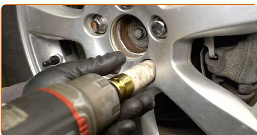
**43** Χαμηλώστε το αυτοκίνητο και χρησιμοποιήστε σταυρό, προκειμένου να σφίξετε τα μπουλόνια των τροχών. Χρησιμοποιήστε κρουστικό καρυδάκι για μπουλονόκλειδο No #19. Χρησιμοποιήστε ένα δυναμόκλειδο. Σφίξτε τη με ροπή 140 Nm.
