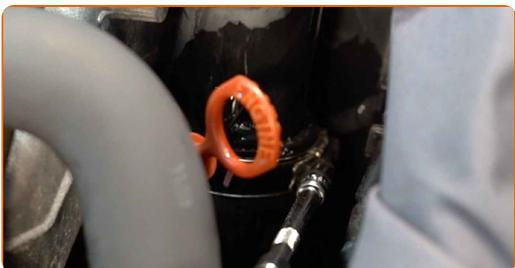
**8** Αφαιρέστε τη σωλήνα της εισαγωγής αέρα.
