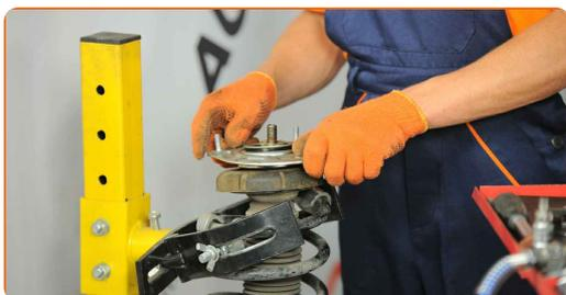
**37** Σφίξτε το παξιμάδι της ράβδου του εμβόλου του γονάτου του αμορτισέρ. Χρησιμοποιήστε ένα ίσιο κατσαβίδι. Χρησιμοποιήστε ένα γερμανοπολύγωνο #21. Χρησιμοποιήστε ένα Τορξ T40. Χρησιμοποιήστε ένα δυναμόκλειδο. Σφίξτε τη με ροπή 70 Nm.
