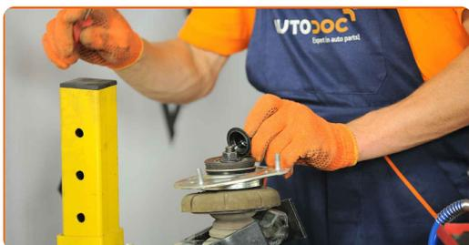
**23** Περάστε από επεξεργασία τη ράβδο του αμορτισέρ. Χρησιμοποιήστε μια συρματοβουρτσα. Χρησιμοποιήστε σπρέι WD-40.
