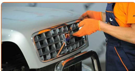
**16** Χρησιμοποιήστε ένα κάλυμμα προστασίας φτερού, για να μην προκαλέσετε ζημιές στη βαφή και τα πλαστικά τμήματα του αυτοκινήτου.
