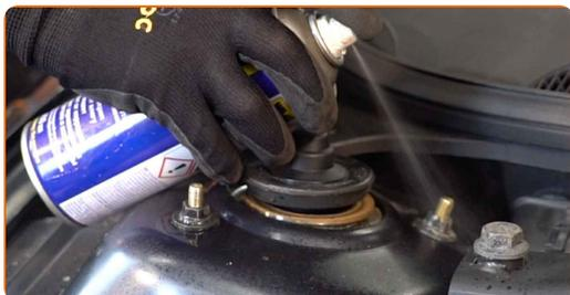
**18** Ξεβιδώστε τα επάνω στοιχεία στερέωσης του γόνατου του αμορτισέρ. Χρησιμοποιήστε ένα καρυδάκι #13. Χρησιμοποιήστε μια καστίνα.
