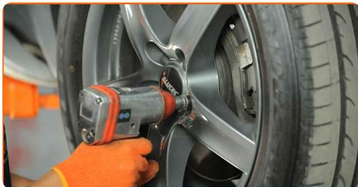
**60** Χαμηλώστε το αυτοκίνητο και χρησιμοποιήστε σταυρό, προκειμένου να σφίξετε τα μπουλόνια των τροχών. Χρησιμοποιήστε κρουστικό καρυδάκι για μπουλονόκλειδο No #19. Χρησιμοποιήστε ένα δυναμόκλειδο. Σφίξτε τη με ροπή 140 Nm.
