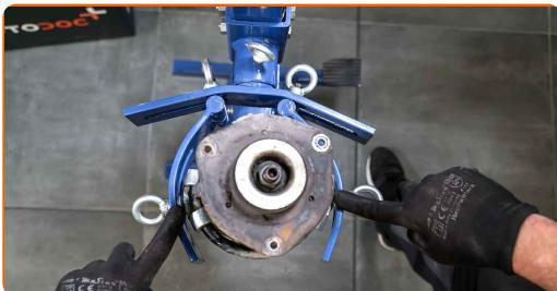
Αντικατάσταση: γόνατο ανάρτησης - VW Beetle Cabrio (5C7, 5C8).
