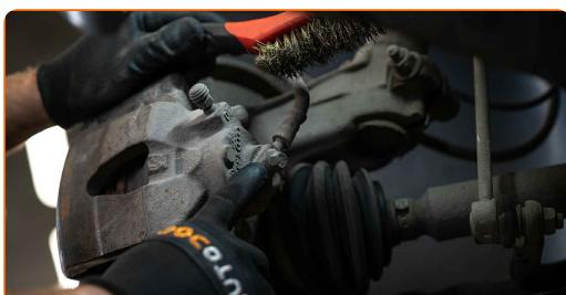
**Αντικατάσταση: δαγκάνα φρένων - VW Beetle Hatchback (5C1, 5C2).
