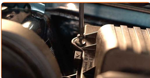
4 Βγάλτε το κολάρο του σωλήνα της εισαγωγής αέρα. Χρησιμοποιήστε μια γκαζοτανάλια.
