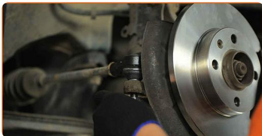
**16** Σφίξτε το παξιμάδι στερέωσης που συνδέει το μπαλάκι του ακρόμπαρου με το μπουαγιέ. Χρησιμοποιήστε ένα καρυδάκι #19. Χρησιμοποιήστε ένα δυναμόκλειδο. Σφίξτε τη με ροπή 35 Nm.
