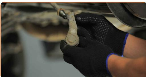
**13** Καθαρίστε τις βάσεις τοποθέτησης του ακρόμπαρου. Χρησιμοποιήστε μια συρματόβουρτσα. Χρησιμοποιήστε σπρέι WD-40.
