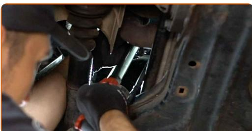
**13** Επεξεργαστείτε τον ακροδέκτη του αισθητήρα οξυγόνου. Χρησιμοποιήστε μονωτικό γράσο.
