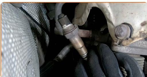
**9** Κόψτε το σπείρωμα για τον καινούριο αισθητήρα οξυγόνου. Χρησιμοποιήστε ένα κολαούζο. Χρησιμοποιήστε μια καστάνια.
