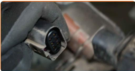
**7** Ξεβιδώστε το στοιχείο στερέωσης του αισθητήρα οξυγόνου. Χρησιμοποιήστε ένα καρυδάκι αισθητήρα οξυγόνου 22 mm. Χρησιμοποιήστε μια καστάνια.
