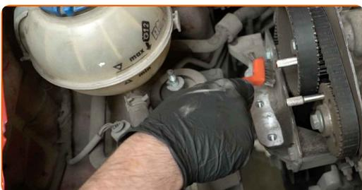
**35** Ξεβιδώστε τα στοιχεία στερέωσης της βάσης του κινητήρα. Χρησιμοποιήστε ένα καρυδάκι #16. Χρησιμοποιήστε μια κασάνια.
