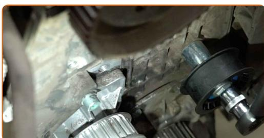
**70** Εφαρμόστε τη βίδες στερέωσης. Χρησιμοποιήστε ένα στεγανοποιητικό υλικό.
