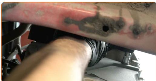
**25** Ανοίξτε τα κλιπ του κάτω καλύμματος του συστήματος χρονισμού. Χρησιμοποιήστε ένα λοστό.
