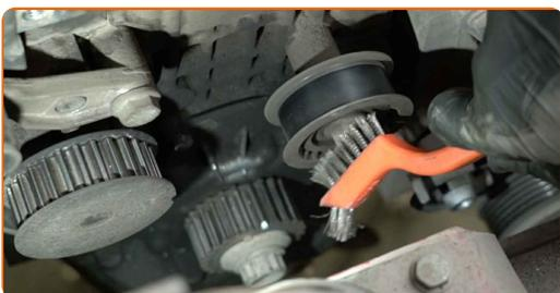
**45** Ξεβιδώστε το στοιχείο στερέωσης της αδρανούς τροχαλίας του ιμάντα χρονισμού. Χρησιμοποιήστε ένα καρυδάκι #15. Χρησιμοποιήστε μια καστάνια.
