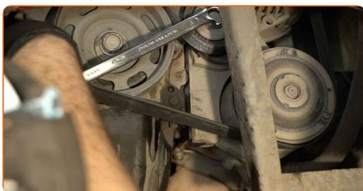
**96** Κάντε στο πλάι την τροχαλία του τεντωτήρα του ιμάντα poly-V. Χρησιμοποιήστε ένα γερμανοπολύγωνο #16.
