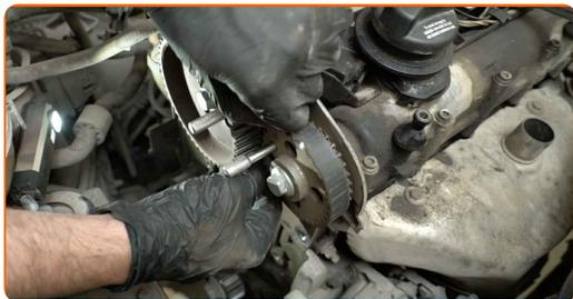
**52** Ξεβιδώστε τα στοιχεία στερέωσης του πλαϊνού καλύμματος του συστήματος χρονισμού. Χρησιμοποιήστε ένα καρυδάκι #10. Χρησιμοποιήστε ένα Άλεν No.H6. Χρησιμοποιήστε μια καστάνια.
