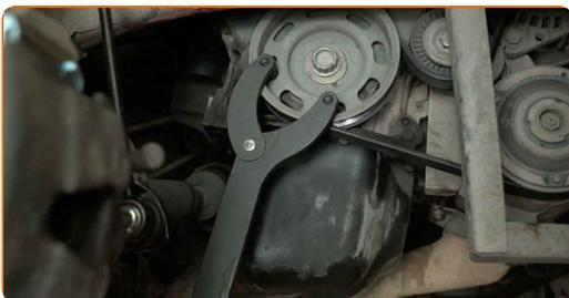
**99** Σφίξτε το στοιχείο στερέωσης της τροχαλίας του στροφαλοφόρου άξονα. Χρησιμοποιήστε ένα πολύσφηνο καρυδάκι (12 δοντιών) No.21. Χρησιμοποιήστε ένα δυναμόκλειδο. Σφίξτε τη με ροπή 90 Nm.+90°
