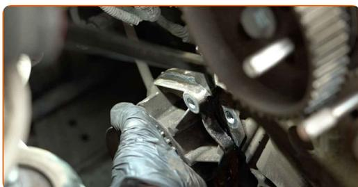
**54** Ξεβιδώστε τα στοιχεία στερέωσης της αντλίας νερού. Χρησιμοποιήστε ένα Άλεν No.H6. Χρησιμοποιήστε μια καστάνια.
