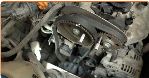
**44** Καθαρίστε το στοιχείο στερέωσης της αδρανούς τροχαλίας του ιμάντα χρονισμού. Χρησιμοποιήστε μια συρματόβουρτσα. Χρησιμοποιήστε σπρέι WD-40
