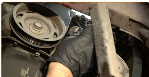
**95** Βιδώστε το στοιχείο στερέωσης της τροχαλίας τεντωτήρα του σπειροειδή μάντα (ιμάντα poly-v). Χρησιμοποιήστε ένα γερμανοπολύγωνο #16.
