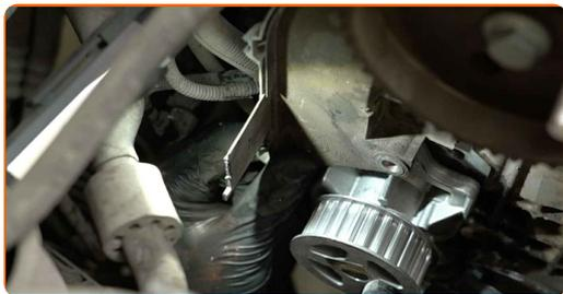
**61** Βιδώστε τα στοιχεία στερέωσης της αντλίας νερού. Χρησιμοποιήστε ένα Άλεν Νο.Η6. Χρησιμοποιήστε μια καστάνια.
