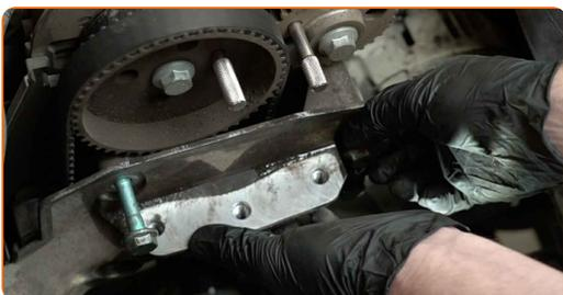
**37** Αφαιρέστε τη βάση του κινητήρα.
