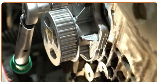
**62** Σφίξτε τα μέσα στοιχεία στερέωσης της αντλίας νερού. Χρησιμοποιήστε ένα Άλεν Νο.Η6. Χρησιμοποιήστε ένα δυναμόκλειδο. Σφίξτε τη με ροπή 20 Nm.
