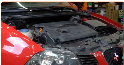
**4** Ξεβιδώστε τα στοιχεία στερέωσης των πόλων της μπαταρίας του αυτοκινήτου. Χρησιμοποιήστε ένα καρυδάκι #10. Χρησιμοποιήστε μια κασάνια.
