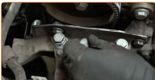
**87** Σφίξτε το επάνω στοιχείο στερέωσης της βάσης του κινητήρα. Χρησιμοποιήστε ένα καρυδάκι #16. Χρησιμοποιήστε ένα δυναμόκλειδο. Σφίξτε τη με ροπή 50 Nm.
