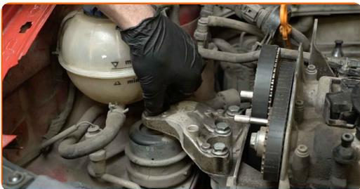
**34** Καθαρίστε τα στοιχεία στερέωσης της βάσης του κινητήρα. Χρησιμοποιήστε μια συρματόβουρτσα. Χρησιμοποιήστε σπρέι WD-40
