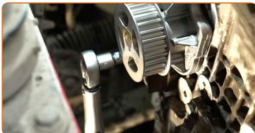
**63** Βιδώστε τα στοιχεία στερέωσης του πλαϊνού καλύμματος του συστήματος χρονισμού. Χρησιμοποιήστε ένα καρυδάκι #10. Χρησιμοποιήστε μια καστάνια.
