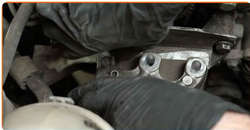
**86** Βιδώστε τα πάνω στοιχεία στερέωσης της βάσης του κινητήρα. Χρησιμοποιήστε ένα καρυδάκι #16. Χρησιμοποιήστε μια καστανία.
