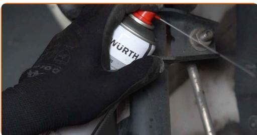
17 Ξεβιδώστε το παξιμάδι και αφαιρέστε το μπαράκι της αντιστρεπτικής δοκού από το γόνατο της ανάρτησης. Χρησιμοποιήστε ένα γερμανοπολύγωνο #16. Χρησιμοποιήστε ένα XZN #6. Χρησιμοποιήστε μια κασάνια.
