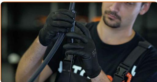
**Αντικατάσταση: μάκτρο καθαριστήρα - VW CADDY IV Κουτί (SAA, SAH).
