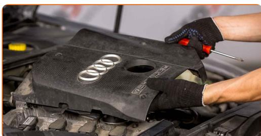
**5** Ξεκουμπώστε τις φίσες από τους πολλαπλασιαστές. Χρησιμοποιήστε ένα ίσιο κατσαβίδι.
