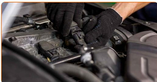
**16** Τοποθετήστε το κάλυμμα του κινητήρα και ασφαλίστε το.
