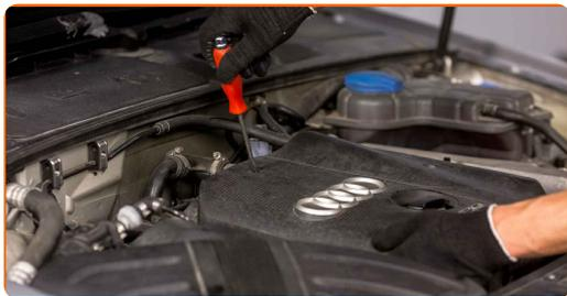
**17** Σφίξτε τα στοιχεία στερέωσης του καλύμματος του κινητήρα. Χρησιμοποιήστε ένα ίσιο κατασαβίδι.
