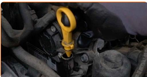
**7** Ξεβιδώστε το καπάκι του περιβλήματος του φίλτρου μαζί με το παλιό στοιχείο φιλτραρίσματος. Χρησιμοποιήστε ένα καρυδάκι #32. Χρησιμοποιήστε μια καστάνια.
