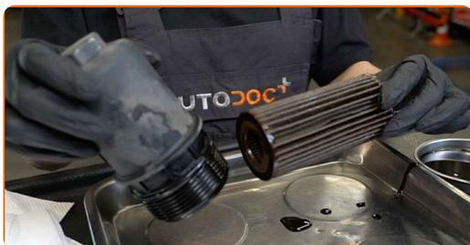
**15** Αφαιρέστε το ο-ριγκ του καπακιού του φίλτρου. Χρησιμοποιήστε ένα ίσιο κατσαβίδι.
