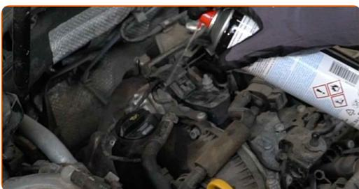
**4** Καθαρίστε το καπάκι του περιβλήματος του φίλτρου λαδιού. Χρησιμοποιήστε ένα σπρέι καθαρισμού γενικής χρήσης.
