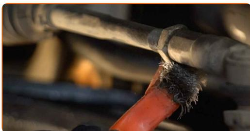
**7** Ξεβιδώστε το παξιμάδι του μπαλακιού στο μουαγιέ. Χρησιμοποιήστε ένα καρυδάκι #18. Χρησιμοποιήστε μια μανέλα κολαούζου.
