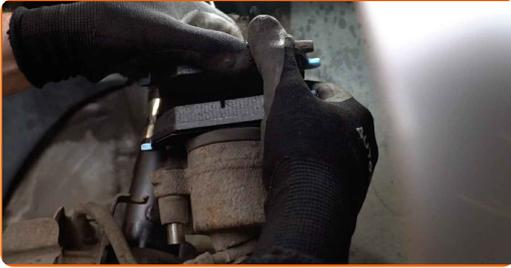
22 Τοποθετήστε τη δαγκάνα του φρένου και σφίξτε τη. Χρησιμοποιήστε ένα Άλεν No.H7 Χρησιμοποιήστε ένα δυναμόκλειδο. Σφίξτε τη με ροπή 30 Nm.
