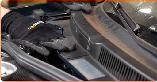
11 Βιδώστε τα στοιχεία στερέωσης του καλύμματος του περιβλήματος του φίλτρου καμπίνας. Χρησιμοποιήστε ένα σταυροκατσάβιδο.
