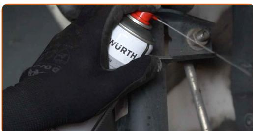
**17** Ξεβιδώστε το παξιμάδι και αφαιρέστε το μπαράκι της αντιστρεπτικής δοκού από το γόνατο της ανάρτησης. Χρησιμοποιήστε ένα γερμανοπολύγωνο #16. Χρησιμοποιήστε ένα XZN #6. Χρησιμοποιήστε μια καστάνια.
