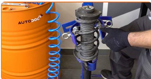
**32** Καθαρίστε το στοιχείο στερέωσης τη ράβδου του αμορτισέρ. Χρησιμοποιήστε μια συρματόβουρτσα. Χρησιμοποιήστε σπρέι WD-40.
