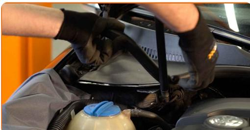
4 Σηκώστε και αφαιρέστε το τροπέτο των υαλοκαθαριστήρων.
