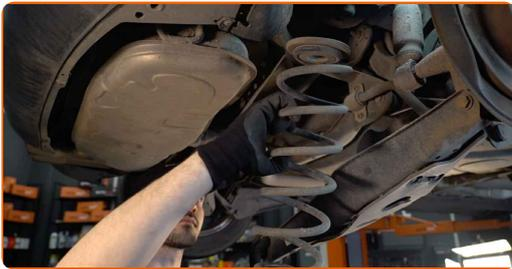
13 Τοποθετήστε το σπειροειδές ελατήριο, μαζί με τις ελαστικές βάσεις στις θέσεις τοποθέτησής του. Χρησιμοποιήστε ένα λοστό.
