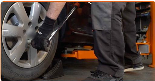
**26** Χαμηλώστε το αυτοκίνητο και χρησιμοποιήστε σταυρό, προκειμένου να σφίξετε τα μπουλόνια των τροχών. Χρησιμοποιήστε ένα δυναμόκλειδο. Σφίξτε τη με ροπή 120 Nm.
