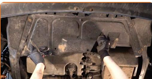
**22** Σφίξτε τα στοιχεία στερέωσης του κάτω καλύμματος του κάρτερ λαδιού. Χρησιμοποιήστε ένα Τορξ T20. Χρησιμοποιήστε μια καστάνια.
