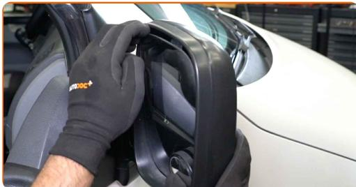
3 Βγάλτε προσεχτικά το κρύσταλλο του καθρέφτη από την προσάρτηση του. Χρησιμοποιήστε ένα πλαστικό εργαλείο ταπετσαρίας. Χρησιμοποιήστε ένα ίσιο κατσαβίδι.
