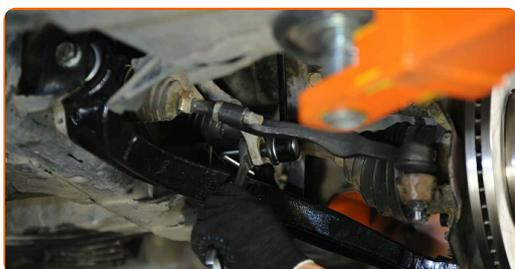
**13** Σφίξτε το στοιχείο στερέωσης που συνδέει το μπαράκι της αντιστρεπτικής στο γόνατο του αμορτισέρ. Χρησιμοποιήστε ένα καρυδάκι #19. Χρησιμοποιήστε ένα δυναμόκλειδο. Σφίξτε τη με ροπή 60 Nm.+45°
