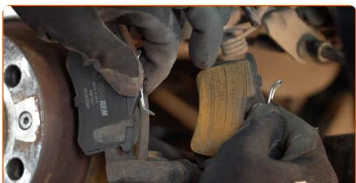
Αντικατάσταση: τακάκια φρένων - VW New Beetle Hatchback (9C1, 1C1).
