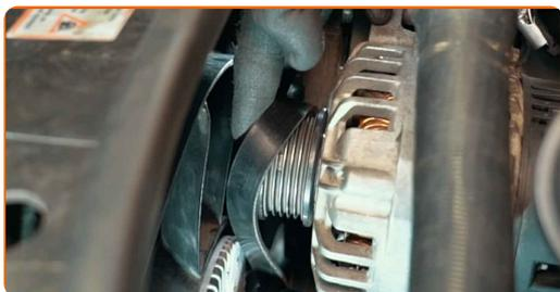
**15** Βιδώστε το στοιχείο στερέωσης της τροχαλίας τεντωτήρα του ιμάντα του συμπιεστή του AC. Χρησιμοποιήστε ένα γερμανοπλύγωνο #17. Χρησιμοποιήστε ένα Άλεν Νο.Η7. Χρησιμοποιήστε μια καστίνα.
