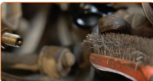
13 Περάστε από επεξεργασία τις βάσεις τοποθέτησης του ακρόμπαρου. Χρησιμοποιήστε γράσο χαλκού.
