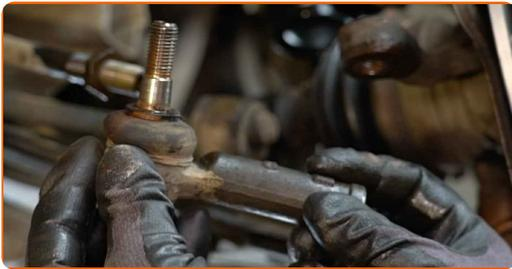
12 Καθαρίστε τις βάσεις τοποθέτησης του ακρόμπαρου. Χρησιμοποιήστε μια συρματόβουρτσα. Χρησιμοποιήστε ένα σπρέι καθαρισμού γενικής χρήσης.
