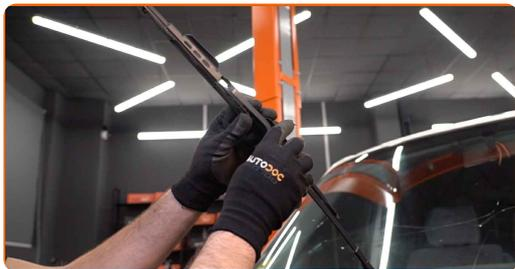
4 Περιστρέψτε το μάκτρο του υαλοκαθαριστήρα κατά ενενήντα μοίρες. Αφαιρέστε το μάκτρο από το βραχίονα του υαλοκαθαριστήρα.
