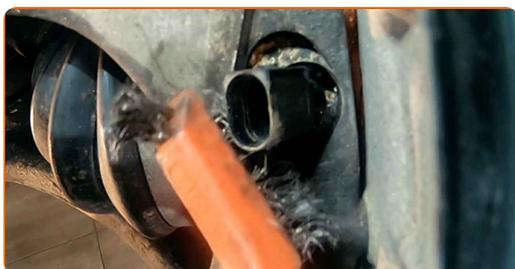
**8** Ξεβιδώστε το μέσο στερέωσης του αισθητήρα ABS. Χρησιμοποιήστε ένα Άλεν Νο.Η5. Χρησιμοποιήστε μια κασάνια.
