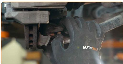
**61** Σφίξτε τα στοιχεία στερέωσης που συνδέουν τον σφαιρικό σύνδεσμο με τον βραχίονα ελέγχου. Χρησιμοποιήστε ένα καρυδάκι #16. Χρησιμοποιήστε ένα δυναμόκλειδο. Σφίξτε τη με ροπή 60 Nm.
