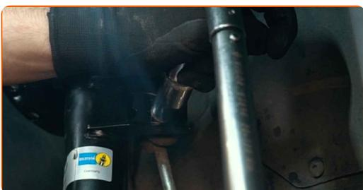
**67** Τοποθετήστε και σφίξτε τη βίδα του άξονα κίνησης. Χρησιμοποιήστε ένα καρυδάκι #27. Χρησιμοποιήστε μια καστάνια.
