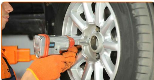
**22** Χαμηλώστε το αυτοκίνητο και χρησιμοποιήστε σταυρό, προκειμένου να σφίξετε τα μπουλόνια των τροχών. Χρησιμοποιήστε κρουστικό καρυδάκι για μπουλονόκλειδο No #17. Χρησιμοποιήστε ένα δυναμόκλειδο. Σφίξτε τη με ροπή 120 Nm.
