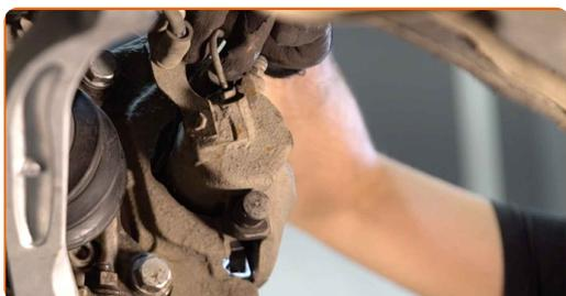
**10** Ξεβιδώστε τον σφιγκτήρα της δαγκάνας των φρένων. Χρησιμοποιήστε ένα Άλεν No.H7 Χρησιμοποιήστε μια καστίνα.
