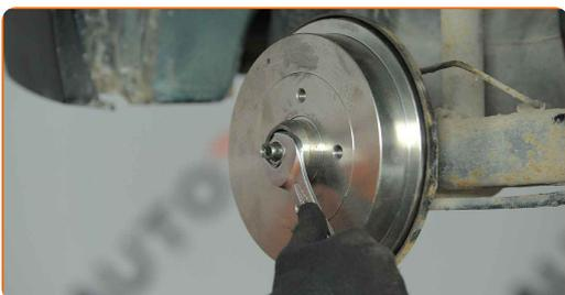
**27** Τοποθετήστε την κοπίλια του παξιμαδιού στερέωσης του ρουλεμάν της πλήμνης. Χρησιμοποιήστε ένα σφυρί. Χρησιμοποιήστε κοφτάκι.
