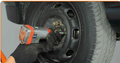
**32** Χαμηλώστε το αυτοκίνητο και χρησιμοποιήστε σταυρό, προκειμένου να σφίξετε τα μπουλόνια των τροχών. Χρησιμοποιήστε κρουστικό καρυδάκι για μπουλονόκλειδο No #17. Χρησιμοποιήστε ένα δυναμόκλειδο. Σφίξτε τη με ροπή 120 Nm.
