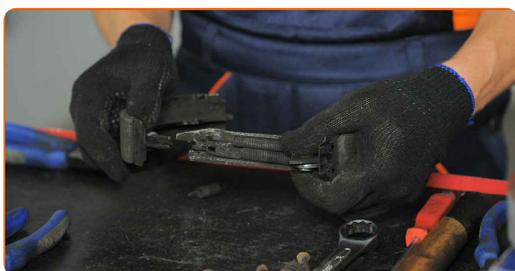
**17** Αποσυναρμολογήστε περαιτέρω το επάνω ελατήριο συγκράτησης και τον μηχανισμό του ρυθμιστή. Κάντε χρήση πένσας.
