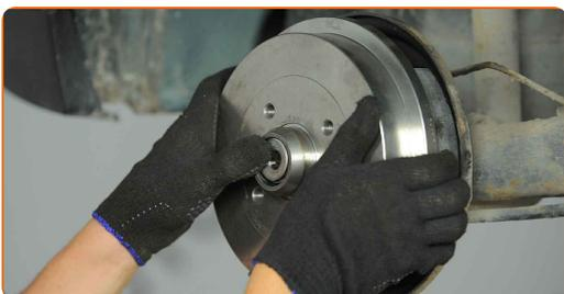
**26** Βιδώστε το στοιχείο στερέωσης του μουαγιέ τροχού. Χρησιμοποιήστε ένα γερμανοπολύγωνο #24.
