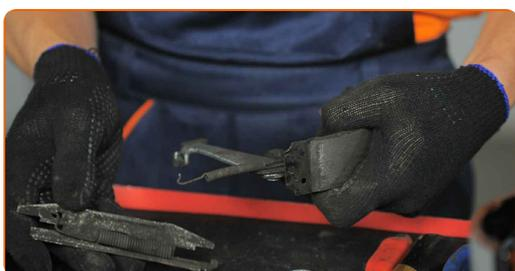
**18** Τοποθετήστε το επάνω ελατήριο συγκράτησης και ρυθμίστε το μηχανισμό των νέων σιαγώνων. Κάντε χρήση πένσας.
