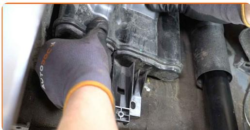
**39** Σφίξτε το στοιχείο στερέωσης του δοχείου αναθυμιάσεων. Χρησιμοποιήστε ένα καρυδάκι #13. Χρησιμοποιήστε ένα δυναμόκλειδο. Σφίξτε τη με ροπή 12 Nm.
