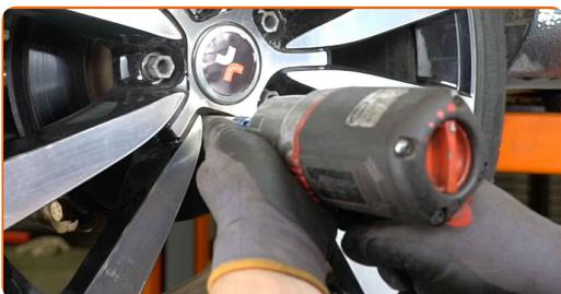
**51** Χαμηλώστε το αυτοκίνητο και χρησιμοποιήστε σταυρό, προκειμένου να σφίξετε τα μπουλόνια των τροχών. Χρησιμοποιήστε κρουστικό καρυδάκι για μπουλονόκλειδο Νο #17. Χρησιμοποιήστε ένα δυναμόκλειδο. Σφίξτε τη με ροπή 120 Nm.
