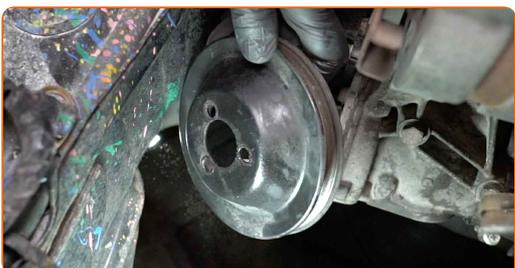
**18** Ξεβιδώστε τα στοιχεία στερέωσης του περιβλήματος της αντλίας (τρόμπας) νερού. Χρησιμοποιήστε ένα καρυδάκι #10. Χρησιμοποιήστε μια κασάνια.
