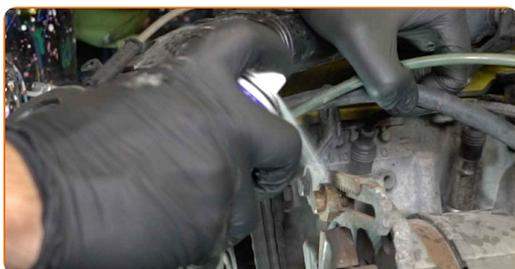
**14** Χαλαρώστε τα στοιχεία στερέωσης του δυναμό. Χρησιμοποιήστε ένα γερμανοπολύγωνο #13.
