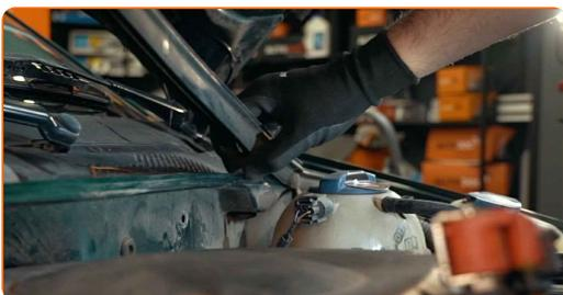
**8** Σηκώστε και αφαιρέστε το τροπέτο των υαλοκαθαριστήρων.
