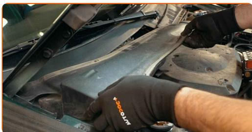
**15** Τοποθετήστε την τσιμούχα του τροπέτου των υαλοκαθαριστήρων.
