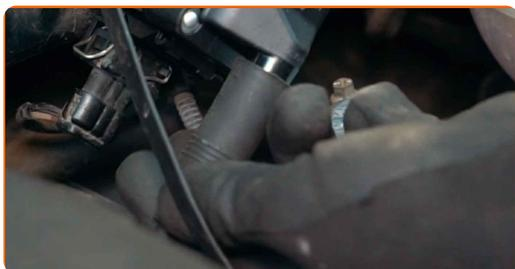
**14** Τοποθετήστε και ασφαλίστε του τροπέτο των υαλοκαθαριστήρων.
