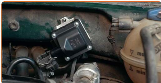
**10** Σφίξτε τον πολλαπλασιαστή. Χρησιμοποιήστε ένα καρυδάκι #10. Χρησιμοποιήστε ένα δυναμόκλειδο. Σφίξτε τη με ροπή 7 Nm.
