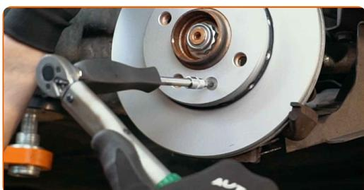
**63** Τοποθετήστε τη δαγκάνα του φρένου και σφίξτε τη. Χρησιμοποιήστε ένα Άλεν Νο.Η6 Χρησιμοποιήστε ένα δυναμόκλειδο. Σφίξτε τη με ροπή 25 Nm.
