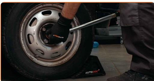
**72** Σφίξτε τα μπουλόνια του τροχού, σταυρωτά. Χρησιμοποιήστε κρουστικό καρυδάκι για μπουλονόκλειδο No #17. Χρησιμοποιήστε ένα δυναμόκλειδο. Σφίξτε τη με ροπή 110 Nm.
