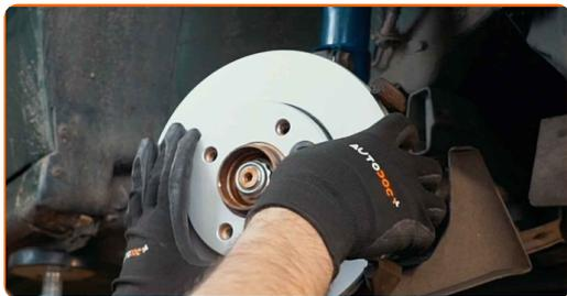
**62** Σφίξτε τις βίδες του δίσκου των φρένων. Χρησιμοποιήστε ένα Τορξ T27. Χρησιμοποιήστε ένα δυναμόκλειδο. Σφίξτε τη με ροπή 9 Nm.
