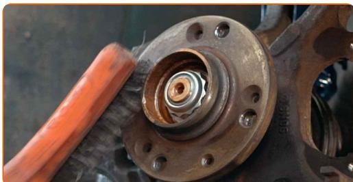
**60** Καθαρίστε τη βάση της δαγκάνας των φρένων από τη βρωμιά και τη σκόνη. Χρησιμοποιήστε μια συρματόβουρτσα. Χρησιμοποιήστε καθαριστικό φρένων.
