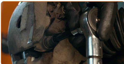
**64** Περάστε από επεξεργασία τα στοιχεία στερέωσης του μπαλακιού του ακρόμπαρου. Επεξεργαστείτε το συνδετήρα άξονα μετάδοσης κίνησης. Περάστε από επεξεργασία το στοιχείο στερέωσης που συνδέει το μπαλάκι του ακρόμπαρου με το μουαγιέ. Περάστε από επεξεργασία τα στοιχεία στερέωσης του γονάτου του αμορτισέρ. Χρησιμοποιήστε γράσο χαλκού.
