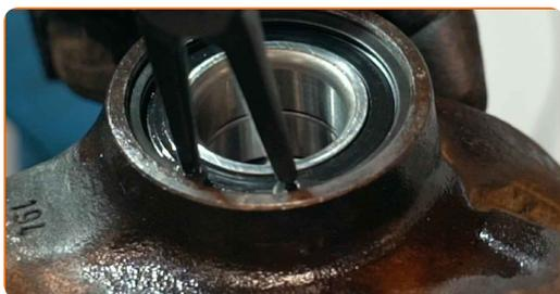
**39** Επεξεργαστείτε τα στοιχεία στερέωσης του μπουαγιέ τροχού. Χρησιμοποιήστε σπρέι WD-40.
