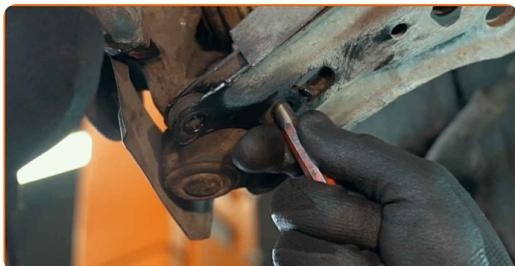
**48** Βιδώστε το στοιχείο στερέωσης που συνδέει το μπαλάκι με το ψαλίδι. Χρησιμοποιήστε ένα καρυδάκι #13. Χρησιμοποιήστε μια καστάνια.
