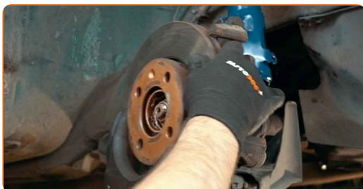
**14** Ξεβιδώστε το στοιχείο στερέωσης που συνδέει τον άξονα κίνησης στην πλήμνη του τροχού. Χρησιμοποιήστε ένα καρνδάκι #30. Χρησιμοποιήστε μια καστίνα.
