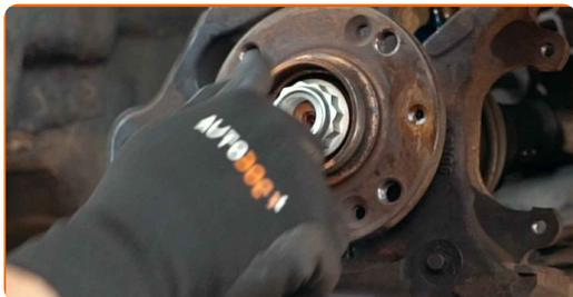
**58** Σφίξτε το παξιμάδι του άξονα κίνησης. Χρησιμοποιήστε ένα καρυδάκι #30. Χρησιμοποιήστε μια καστίνα.
