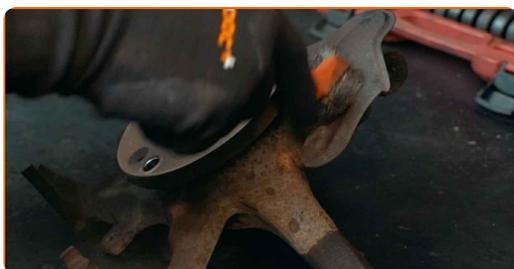
**28** Ξεβιδώστε τα στοιχεία στερέωσης του λαμαρινένιου προστατευτικού του δίσκου των φρένων. Χρησιμοποιήστε ένα καρνδάκι #8. Χρησιμοποιήστε μια κασάνια.
