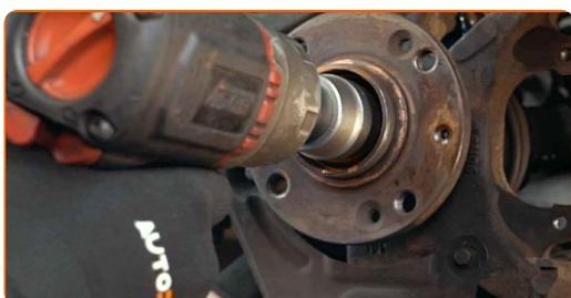
**59** Καθαρίστε την πλήμνη. Χρησιμοποιήστε μια συρματόβουρτσα. Χρησιμοποιήστε ένα σπρέι καθαρισμού γενικής χρήσης. Καθαρίστε το σημείο επαφής. Χρησιμοποιήστε γράσο χαλκού.
