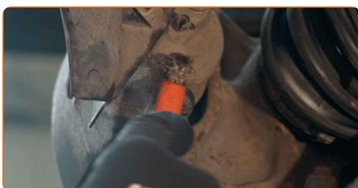
9 Ξεβιδώστε τον σφιγκτήρα της δαγκάνας των φρένων. Χρησιμοποιήστε ένα Άλεν No.H6. Χρησιμοποιήστε μια καστίνα.
