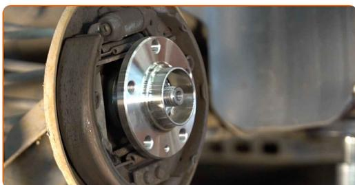
**14** Σφίξτε την πλήμνη. Χρησιμοποιήστε ένα πολύσφηνο (12άρι) καρυδάκι #30. Χρησιμοποιήστε ένα δυναμόκλειδο. Σφίξτε τη με ροπή 175 Nm.
