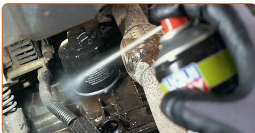
**11** Ξεβιδώστε το φίλτρο λαδιού. Χρησιμοποιήστε ένα καρυδάκι #30. Χρησιμοποιήστε μια καστάνια.
