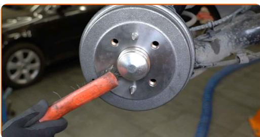
**27** Περάστε από επεξεργασία την επιφάνεια στην οποία η ζάντα ακουμπά επάνω στο ταμπόρο. Χρησιμοποιήστε κεραμικό γράσο υψηλής θερμοκρασίας.
