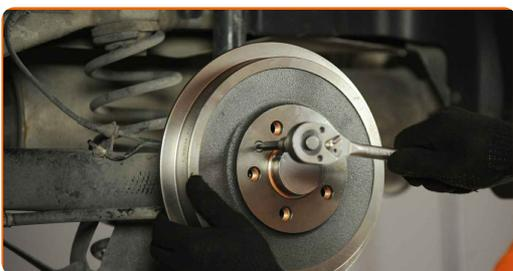
**26** Καθαρίστε το σημείο τοποθέτησης της ζάντας του τροχού. Χρησιμοποιήστε μια συρματόβουρτσα.
