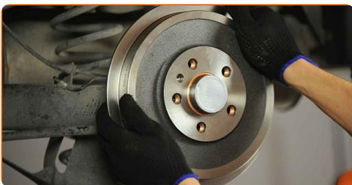
**25** Σφίξτε τα στοιχεία στερέωσης του ταμπόρου των φρένων. Χρησιμοποιήστε ένα Τορξ T30. Χρησιμοποιήστε ένα δυναμόκλειδο. Σφίξτε τη με ροπή 4 Nm.
