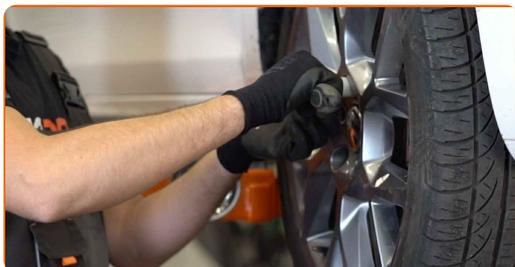
**24** Χαμηλώστε το αυτοκίνητο και χρησιμοποιήστε σταυρό, προκειμένου να σφίξετε τα μπουλόνια των τροχών. Χρησιμοποιήστε ένα δυναμόκλειδο. Σφίξτε τη με ροπή 120 Nm.
