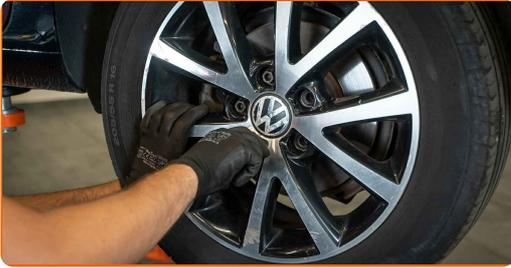
28 Χαμηλώστε το αυτοκίνητο και χρησιμοποιήστε σταυρό, προκειμένου να σφίξετε τα μπουλόνια των τροχών. Χρησιμοποιήστε ένα δυναμόκλειδο. Σφίξτε τη με ροπή 120 Nm.
