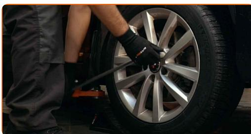
**3** Σηκώστε το μπροστινό μέρος του αυτοκινήτου και στερεώστε το σε στηρίγματα.
