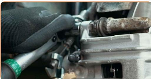
**37** Καθαρίστε το σημείο τοποθέτησης της ζάντας του τροχού. Χρησιμοποιήστε μια συρματόβουρτσα.
