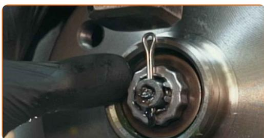
**31** Τοποθετήστε το καπάκι του παξιμαδιού του μουγιέ. Χρησιμοποιήστε μια λαστιχένια ματσόλα.
