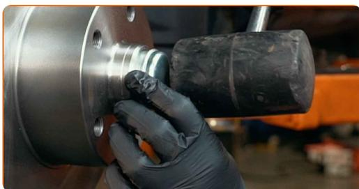
**32** Καθαρίστε τη βάση της δαγκάνας των φρένων από τη βρωμιά και τη σκόνη. Χρησιμοποιήστε μια συρματόβουρτσα. Χρησιμοποιήστε καθαριστικό φρένων.
