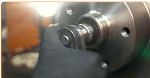
**30** Τοποθετήστε μια καινούρια κοπίλια του παξιμαδιού του μουγιέ. Χρησιμοποιήστε ένα σφυρί. Χρησιμοποιήστε ένα λοστό.
