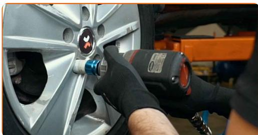
42 Χαμηλώστε το αυτοκίνητο και χρησιμοποιήστε σταυρό, προκειμένου να σφίξετε τα μπουλόνια των τροχών. Χρησιμοποιήστε κρουστικό καρυδάκι για μπουλονόκλειδο Νο #17. Χρησιμοποιήστε ένα δυναμόκλειδο. Σφίξτε τη με ροπή 120 Nm.
