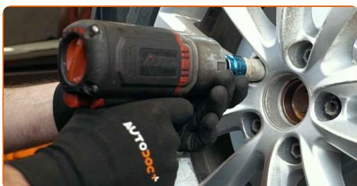
21 Χαμηλώστε το αυτοκίνητο και χρησιμοποιήστε σταυρό, προκειμένου να σφίξετε τα μπουλόνια των τροχών. Χρησιμοποιήστε κρουστικό καρυδάκι για μπουλονόκλειδο Νο #17. Χρησιμοποιήστε ένα δυναμόκλειδο. Σφίξτε τη με ροπή 120 Nm.
