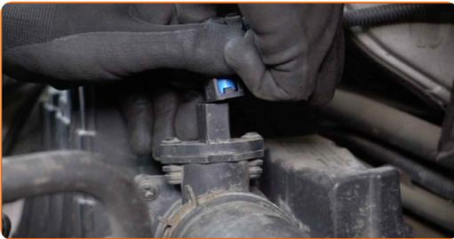
**4** Βγάλτε το κολάρο του σωλήνα της εισαγωγής αέρα. Κάντε χρήση μιας πένσας σφικκτήρων clic-R.
