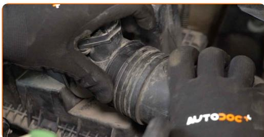
**16** Σφίξτε το κολάρο του σωλήνα εισαγωγής αέρα. Κάντε χρήση μιας πένσας σφιγκτήρων clic-R.
