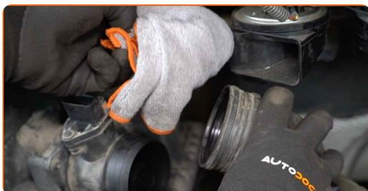
**15** Συνδέστε τον σωλήνα εισαγωγής αέρα στο περίβλημα του φίλτρου λαδιού.
