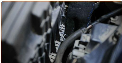
**31** Βγάλτε το κολάρο του σωλήνα της εισαγωγής αέρα. Κάντε χρήση μιας πένσας σφιγκτήρων clic-R.
