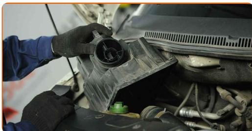
**64** Συνδέστε τον σωλήνα εισαγωγής αέρα στο περίβλημα του φίλτρου λαδιού.
