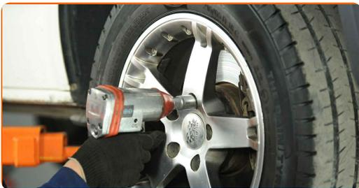
93 Χαμηλώστε το αυτοκίνητο και χρησιμοποιήστε σταυρό, προκειμένου να σφίξετε τα μπουλόνια των τροχών. Χρησιμοποιήστε κρουστικό καρυδάκι για μπουλονόκλειδο No #19. Χρησιμοποιήστε ένα δυναμόκλειδο. Σφίξτε τη με ροπή 180 Nm.
