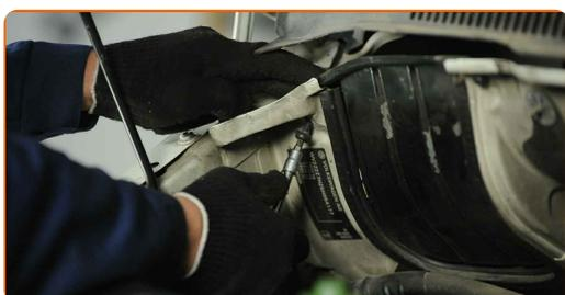
**61** Τοποθετήστε την τσιμούχα του τροπέτου των υαλοκαθαριστήρων.
