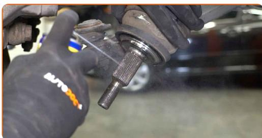
**76** Τοποθετήστε το ακραξόνιο στον άξονα μετάδοσης κίνησης.
