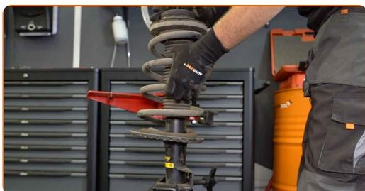
**Αντικατάσταση: βάση αμορτισέρ - VW Transporter V Microbus (7HB, 7HJ, 7EB, 7EJ, 7EF, 7EG, 7HF, 7EC). Συμβουλή:**
