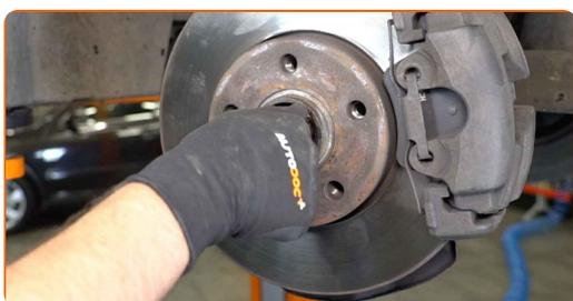
**87** Σφίξτε το παξιμάδι του άξονα κίνησης. Χρησιμοποιήστε ένα καρυδάκι #30. Χρησιμοποιήστε ένα δυναμόκλειδο. Σφίξτε τη με ροπή 200 Nm.
